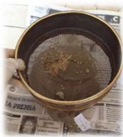
FIGURA 3.2. Determinación de la pedregosidad.
