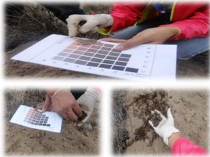
FIGURA 3.1. Determinación Clases Texturales y color del Suelo en campo.
