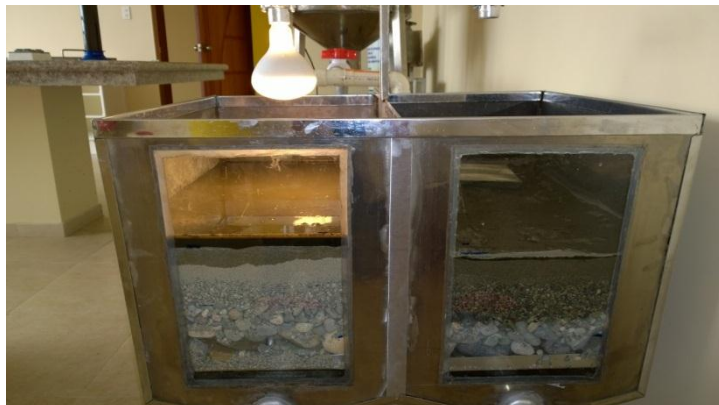
Fotografía 33. Secado de la muestra espesada de lodo concentrado.
