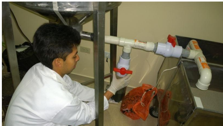
Fotografía 29. Toma de muestra de lodo espesado.
