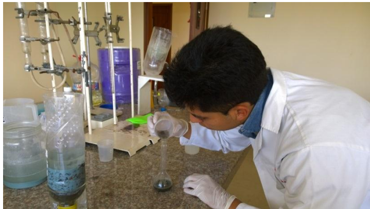
Fotografía 18. Medición de volumen de muestra de lodo.
