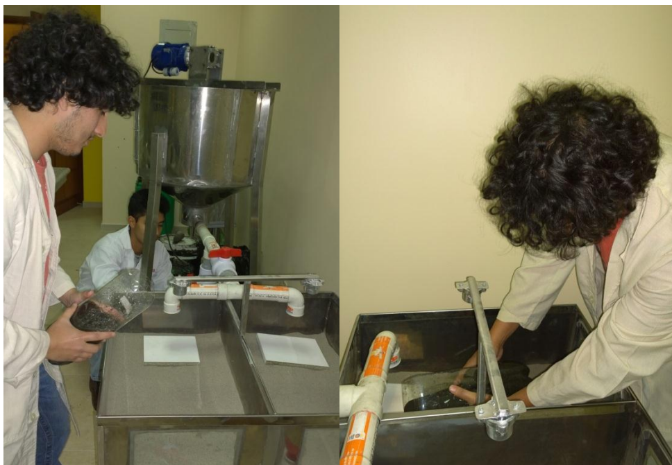
Fotografía 30. Trasvase de lodo espesado a las eras de secado.
