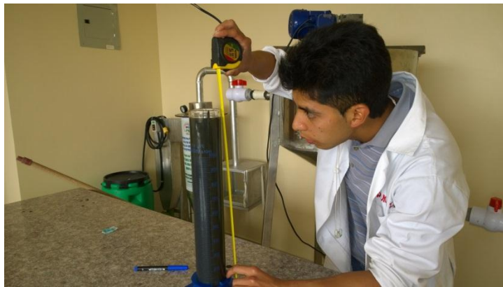
Fotografía 26. Medición de la fase sólida de la muestra de lodo concentrado.
