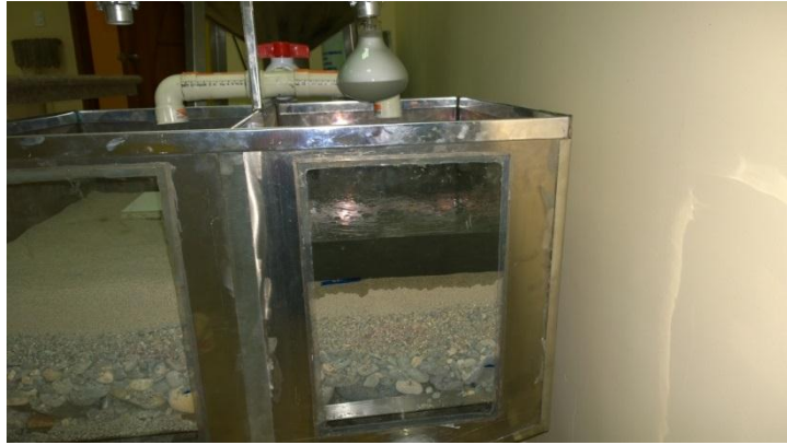
Fotografía 31. Muestra de lodo espesado en las eras de secado.
