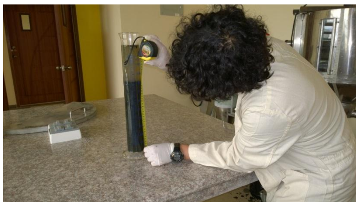
Fotografía 24. Medición de la fase sólida de la muestra de lodo diluido.
