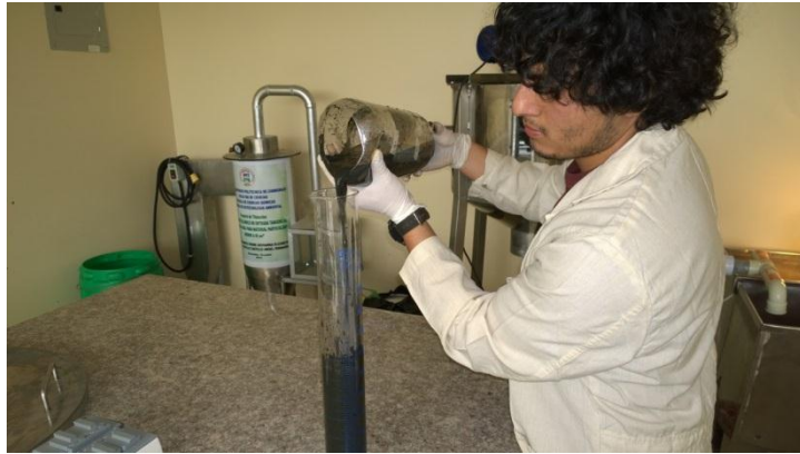
Fotografía 22. Traspase de la muestra de lodo a una probeta.
