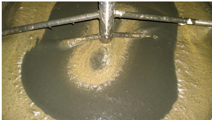
Fotografía 27. Espesado de la muestra de lodo diluido en el espesador de lodos por gravedad.
