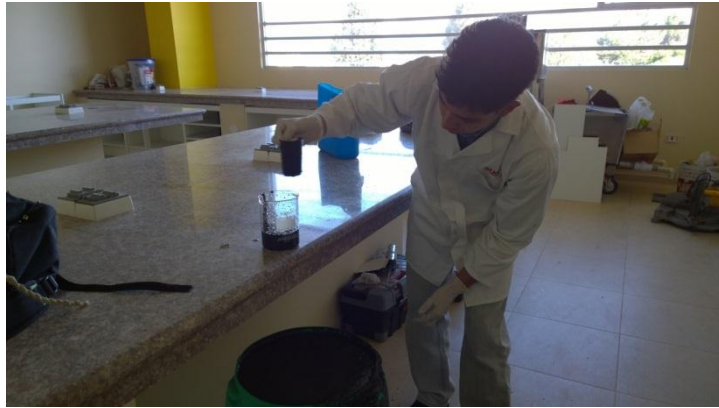
Fotografía 17. Trasvase de lodo a un vaso de precipitación.
