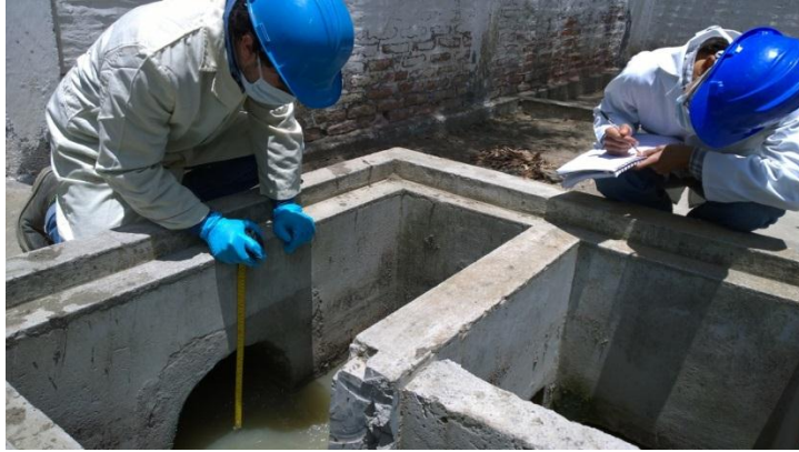
Fotografía 1. Medición del tirante del agua.
