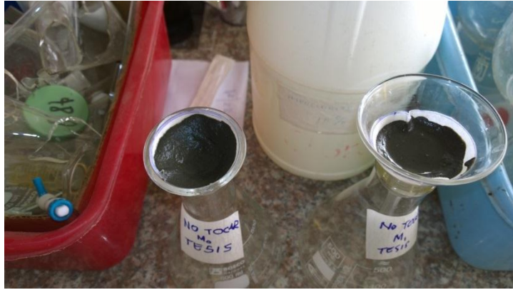
Fotografía 20. Filtración de las muestras de lodo.
