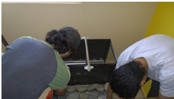
Fotografía 11. Colocación del medio filtrante en las eras de secado.
