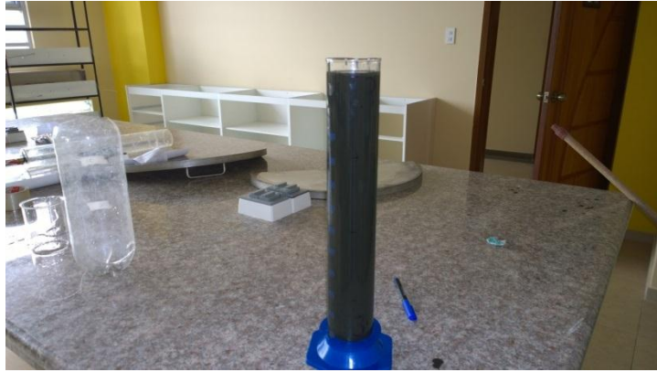
Fotografía 25. Separación de la fase sólida de la muestra de lodo concentrado.
