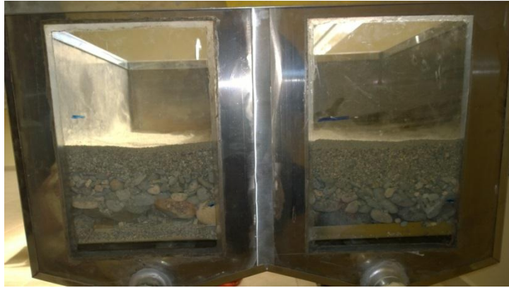
Fotografía 12. Medio filtrante de las eras de secado.
