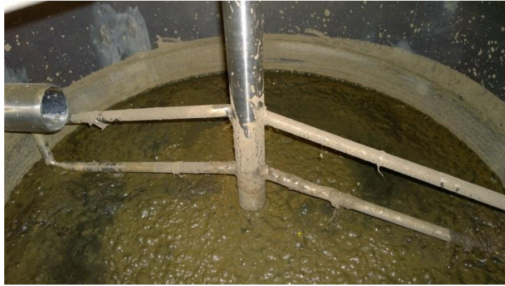
Fotografía 28. Espesado de la muestra de lodo concentrado en el espesador de lodos por gravedad.
