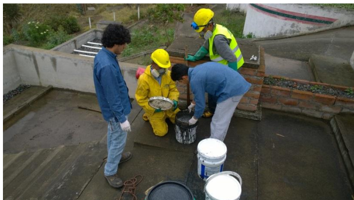
Fotografía 16. Sellado de los contenedores con las muestras de lodo recolectadas.
