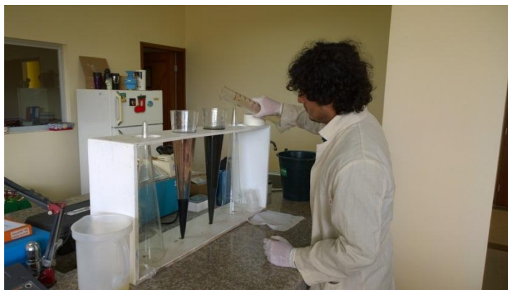
Fotografía 21. Sedimentación de las partículas sólidas en los conos imhoff.
