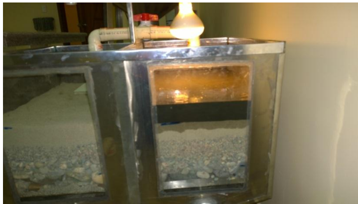
Fotografía 32. Secado de la muestra espesada de lodo diluido.
