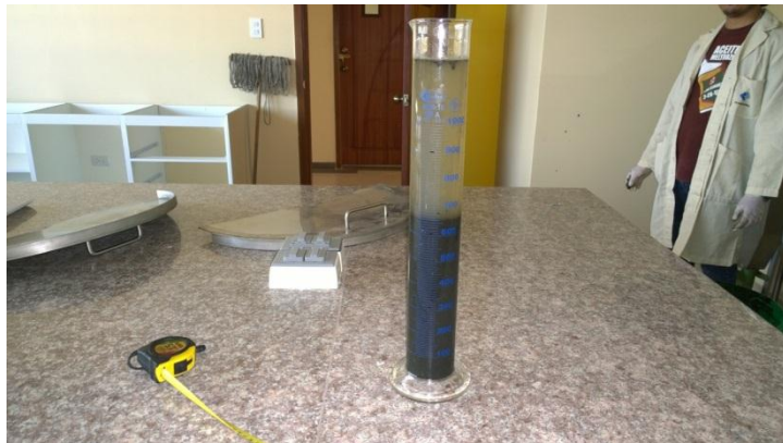
Fotografía 23. Separación de la fase sólida de la muestra de lodo diluido.
