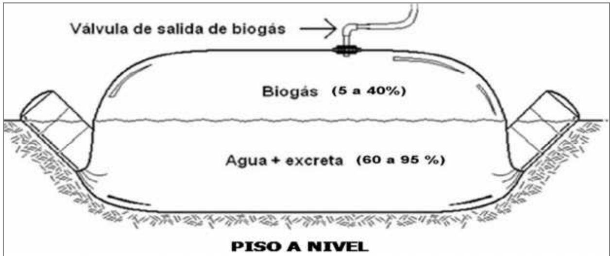
Figura N. 4-2. Digestor tubular de polietileno Fuente: (Marti Herrero)
