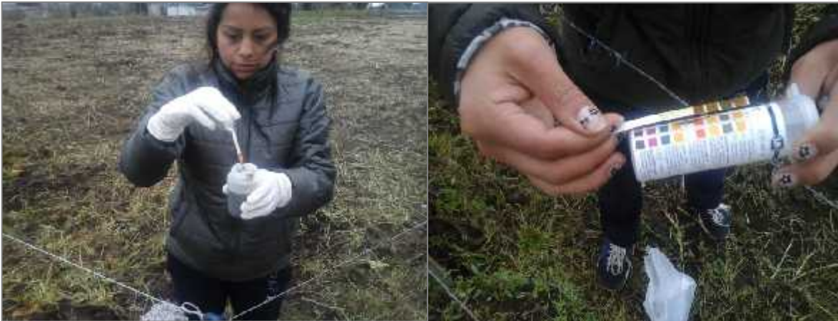
Medición de pH del estiércol en dilución de 1:3 – Análisis In Situ
