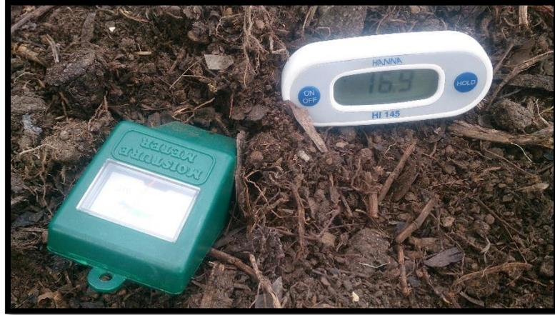
**Figura 11-2:** Toma de datos de humedad y temperatura.
