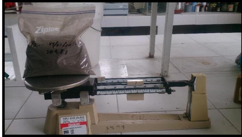
**Figura 13–2:** Pesaje de material final (secado y molido).
