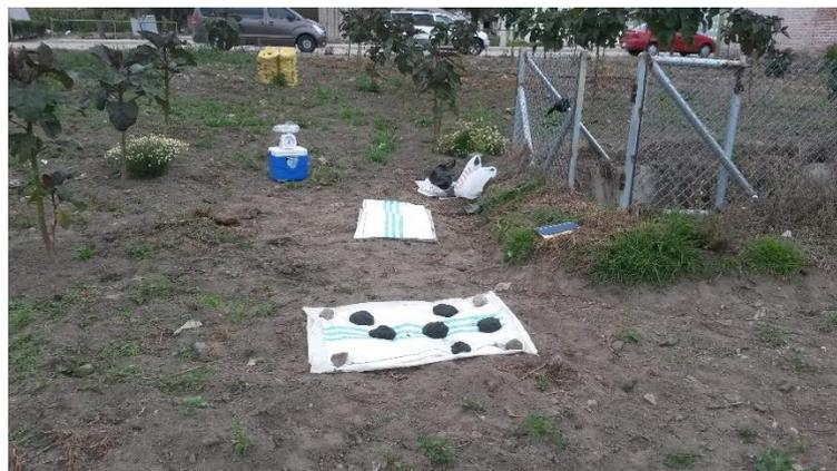
**Fotografía N°3** Muestra compuesta de lodos activos de la fosa séptica
