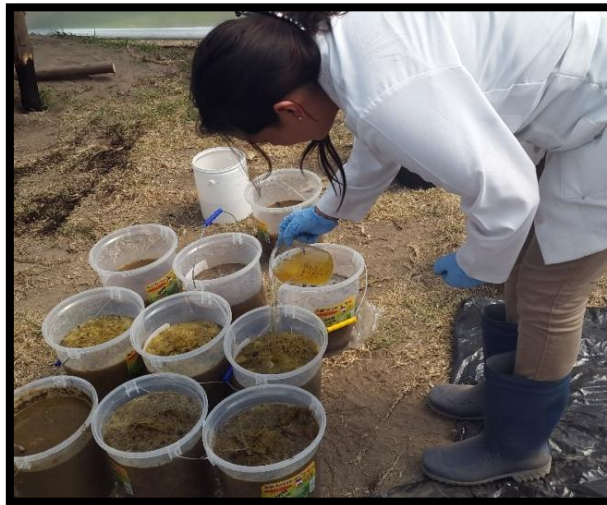
Foto 12: Adición de melaza al biodigestor
