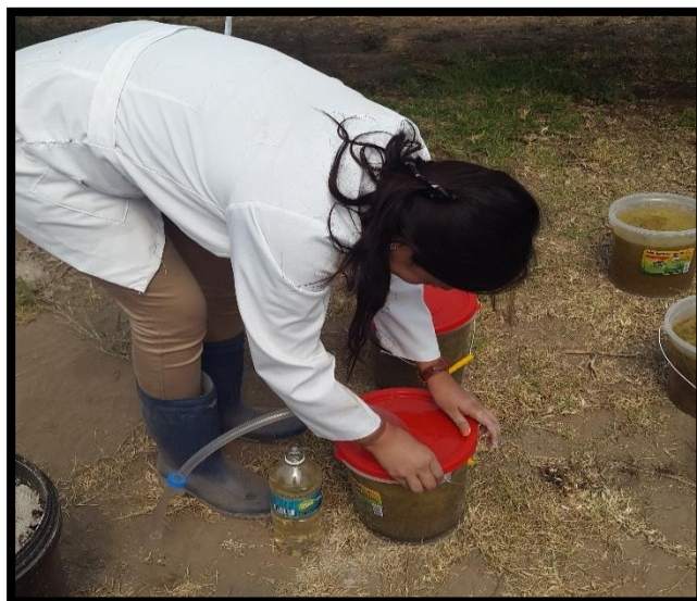
Foto 16: Sellado del biodigestor artesanal.
