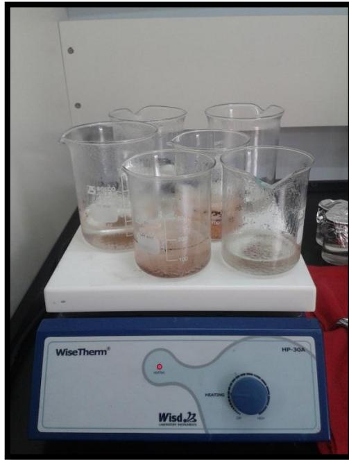
**Anexo 4.** Evaporación de muestras en la placa calefactora
