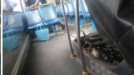
**Anexo 6** Colocación de las sondas en el motor y en el aceite
