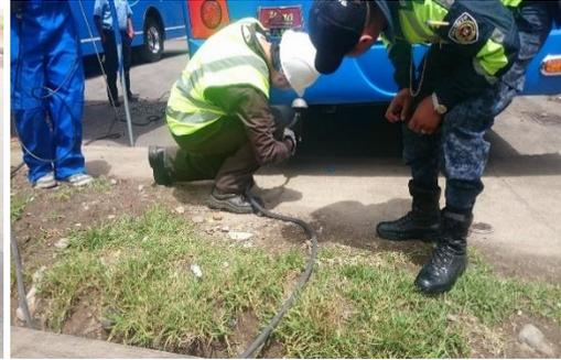
**Anexo 5** Colocación de la Sonda en el tubo de escape del vehículo
