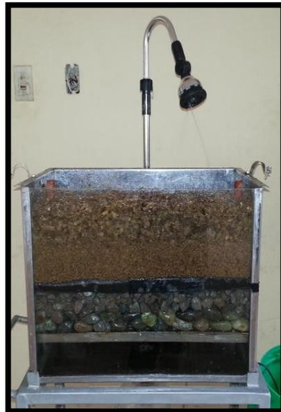
Colocación de la capa de humus sobre los estratos aserrín y viruta
