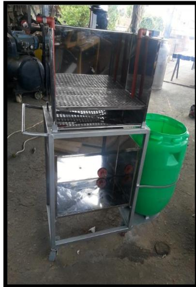
Sistema de aspersión y ventilación del tanque de biofiltración.
