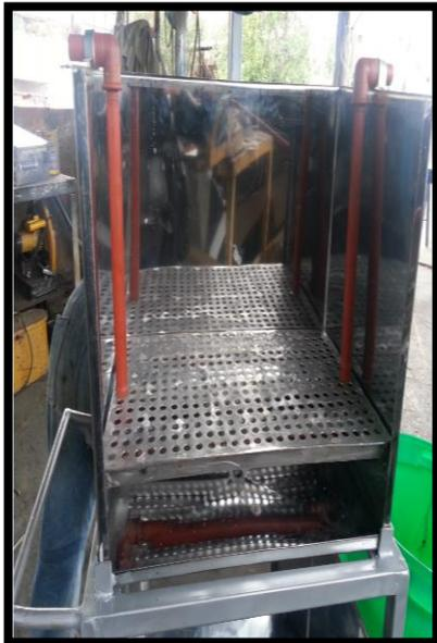
Soporte de metal para el sistema de biofiltración
