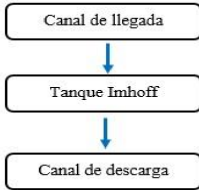
Grafico 2-4: Actual sistema de tratamiento del agua residual
