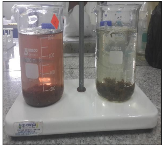
F11: Decantación de flocs
