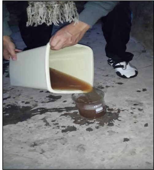
F2: Medición del volumen de agua residual
