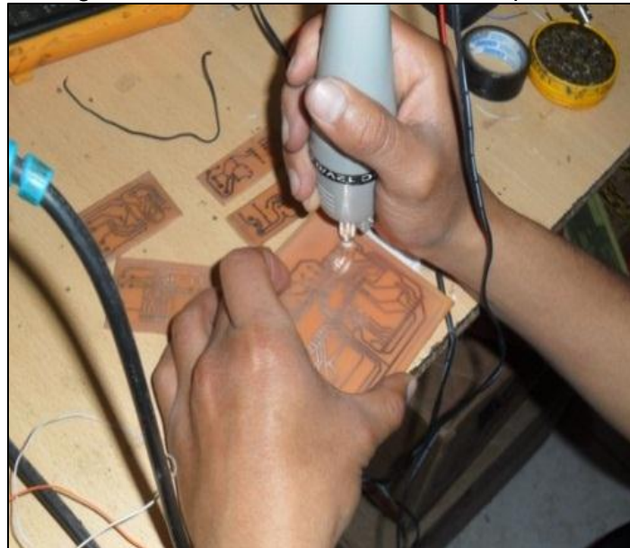
Figura 47. Perforado de los circuitos impresos
