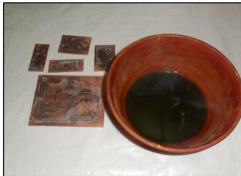
Figura 45. Proceso de corrosión de los circuitos impreso
