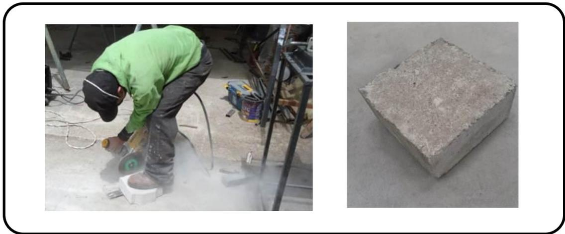
La probeta ha sido tomada de un lote de producción después de 42 días de maduración y cortada de acuerdo a las medidas recomendadas en la norma de tal manera que se pueda ajustar en el porta probetas móvil, y el disco metálico ancho, se debe verificar su ortogonalidad y la superficie totalmente plana en la probeta en caso de no cumplir con lo especificado se debe preparar de tal manera que se tenga un ensayo correcto de desgaste abrasivo.
