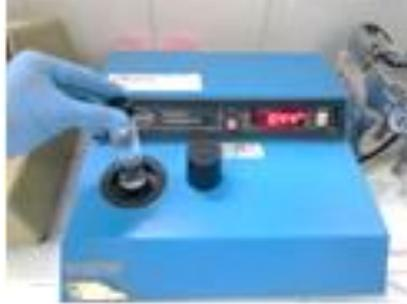
**Fotografía 26. Determinación de pH, temperatura, conductividad, sólidos totales disueltos.**
