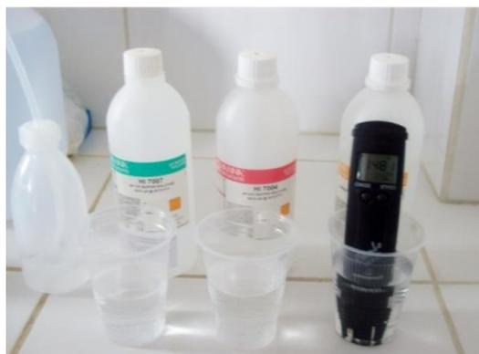
*Fotografía 6. Calibración de Conductividad.*
