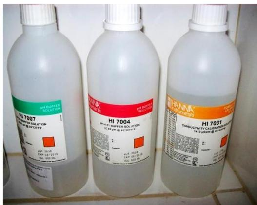
*Fotografía 5. Calibración de pH.*
