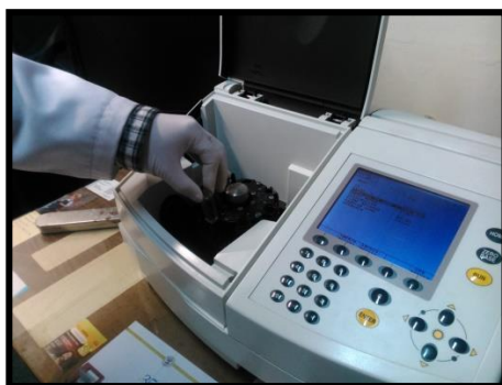
Fotografía 26: Introducción de la celda en el espectrofotómetro UV – visible
