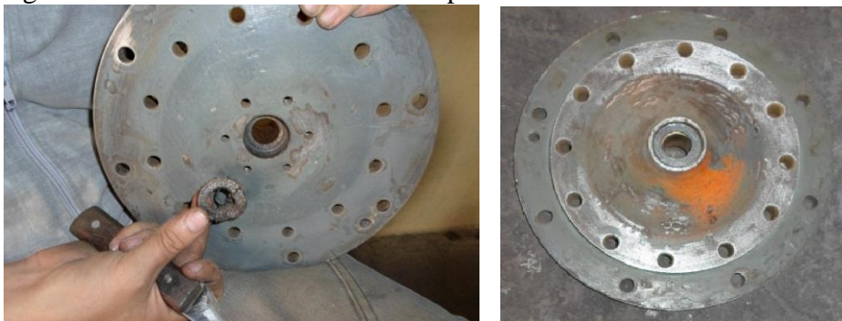
Figura 36. Mantenimiento correctivo aplicado al distribuidor de la turbina
