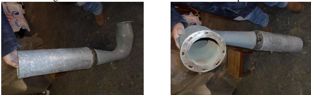
Figura 48. Mantenimiento correctivo al tubo de aspiración
