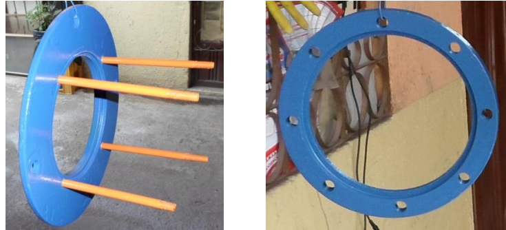
Figura 52. Mantenimiento mejorativo aplicado a las bridas de sujeción del tubo de acrílico transparente
