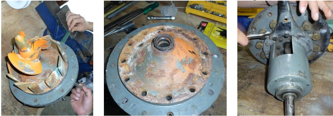
Figura 35. Distribuidor antes del mantenimiento respectivo
