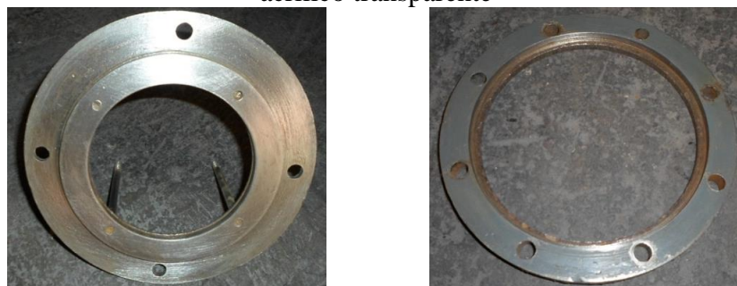
Figura 51. Mantenimiento correctivo aplicado a las bridas de sujeción del tubo de acrílico transparente
