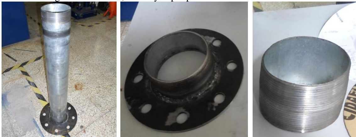
Figura 68. Tubería, bridas y nexo para la instalación de la bomba
