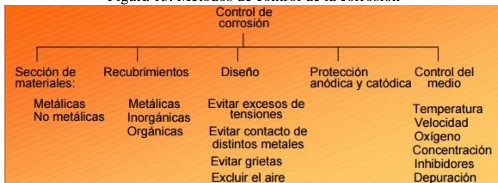
Figura 13. Métodos de control de la corrosión
