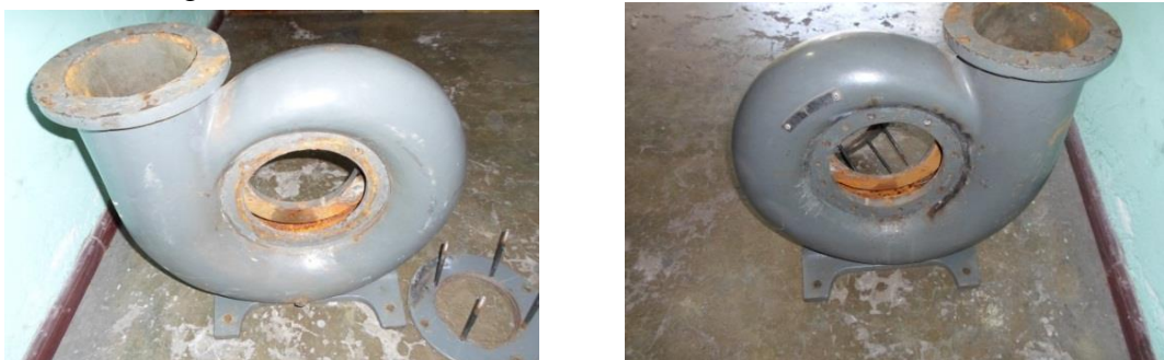
Figura 32. Carcasa exterior e interior antes del mantenimiento
