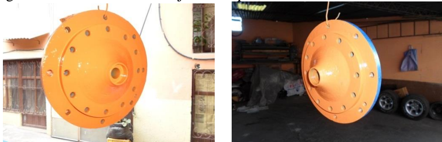
Figura 37. Mantenimiento mejorativo aplicado al distribuidor de la turbina
