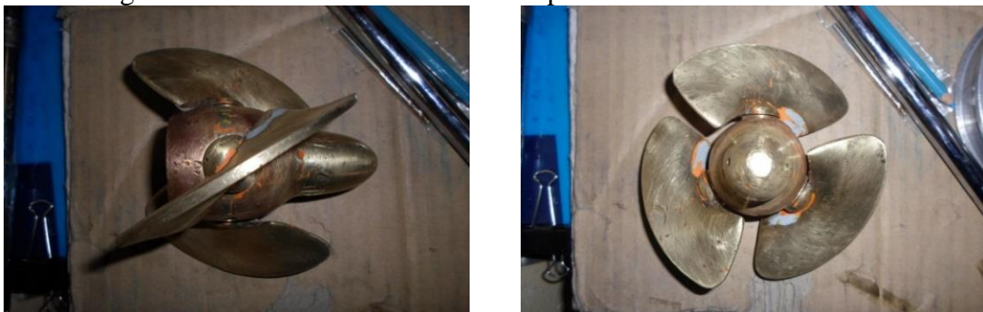
Figura 45. Mantenimiento correctivo aplicado al rodete de la turbina
