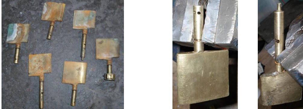
Figura 38. Alabes del distribuidor antes del mantenimiento
