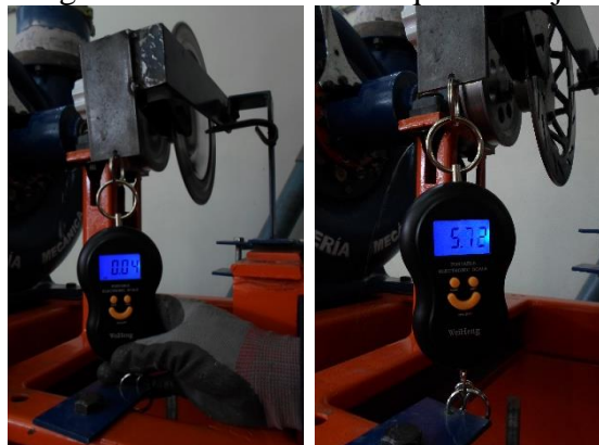
Figura 92. Medición de torque en el eje.
