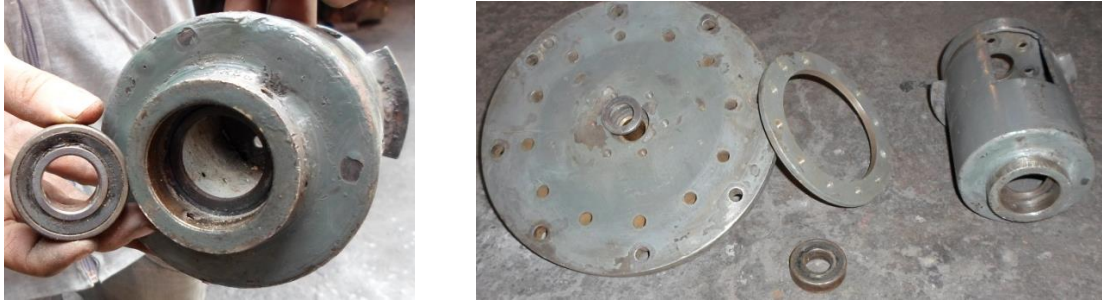
Figura 40. Mantenimiento correctivo aplicado a los componentes del distribuidor
