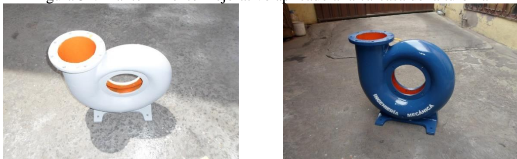
Figura 34. Mantenimiento mejorativo aplicado a la carcasa de la turbina
