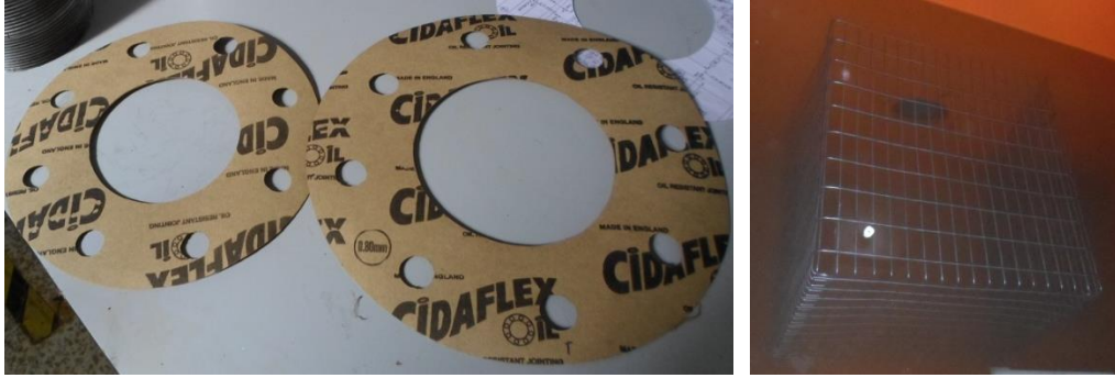
Figura 69. Empaques y filtros de malla metálica.
