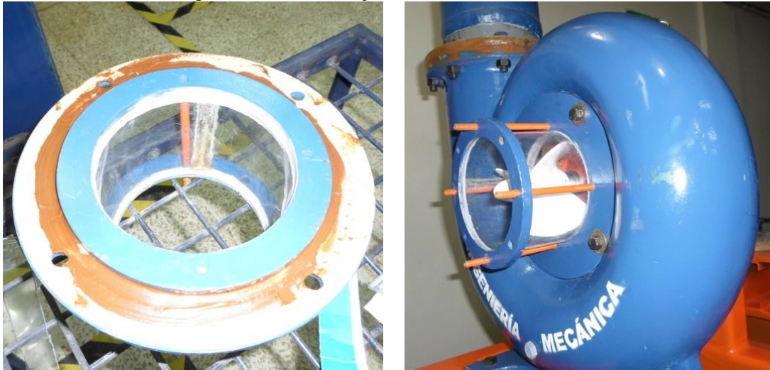
Figura 56. Ensamblaje de la tubería de acrílico
