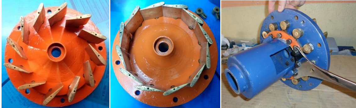
Figura 43. Distribuidor después del mantenimiento realizado
