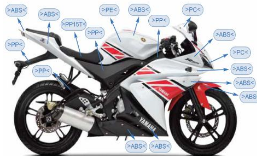
Figura 16. Motocicleta dotada de varios elementos de plástico
