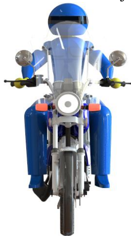
Figura 92. Vista frontal del montaje bases-carenado
