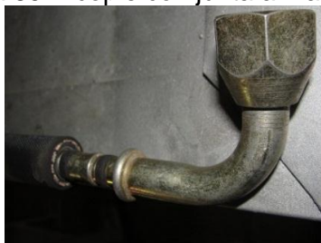
Figura 85. Acople con junta a manguera
