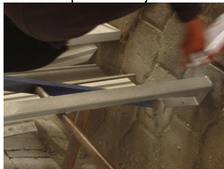
Figura 82. Pintado de soporte de sujeción de la placa eutéctica
