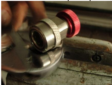
Figura 83. Remache de acople rápido a manguera
