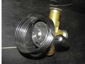
Figura 41. Válvula de expansión, con orificio Nro. 2, regulación externa, para refrigerante R404a, marca Danfoss
