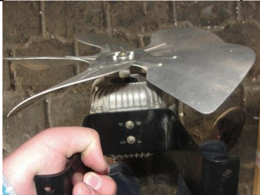
Figura 60. Ensamblado de base, motor y aspa
