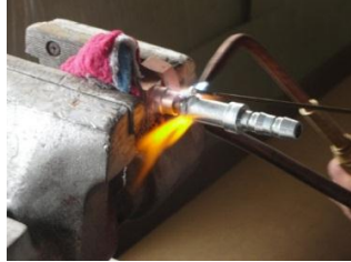
Figura 61. Suelda de válvula rotalock al acople
