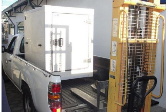
Figura 111. Montaje y ajuste de caja térmica al cajón
