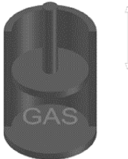
Figura 3. Variación de la presión, temperatura y volumen de un gas ideal de masa m confinado a un cilindro
