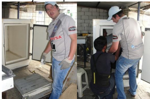
Figura 96. Montaje de la placa eutéctica a la caja térmica
