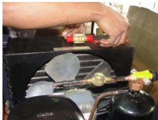
Figura 62. Ensamblado de visor de líquido al acumulador de refrigerante líquido y al ventilador del condensador
