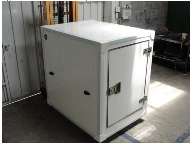
Figura 47. Recubrimiento y acabado de aislamiento exterior
