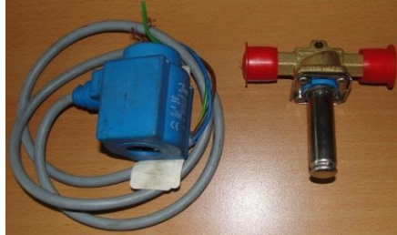
Figura 33. Bobina solenoide marca Danfoss a 110V, y válvula marca Danfoss acoplada y accionada por la bobina
