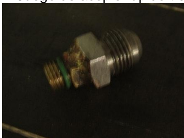
Figura 84. Juego de acople rápido tras suelda
