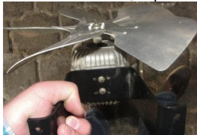
Figura 35. Motor ventilador a 110V, aspa de 8", marca ELCO
