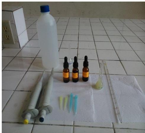
**Fotografía3:** Reactivos y materiales utilizados en la cuantificación de flavonoides totales
