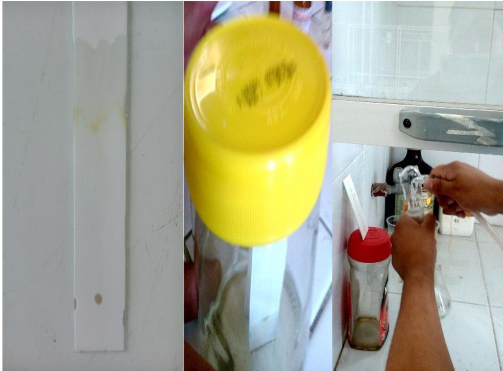
**Fotografía 5:** Análisis cromatográfico de flavonoides
