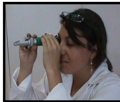
**Fotografía N°12** Determinación Índice de refracción
