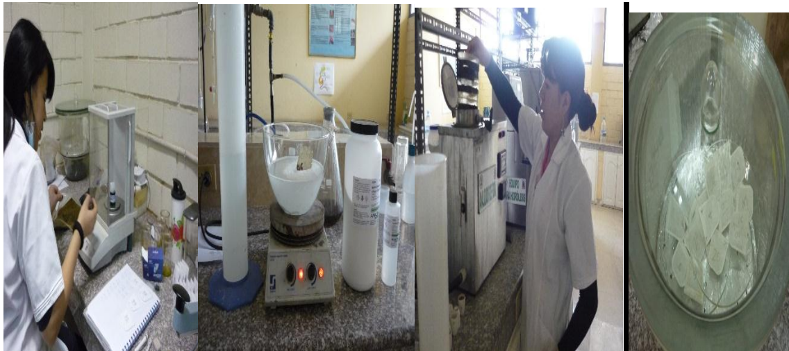
Fotografía No.13 Fibra detergente neutra Método de Ankom
