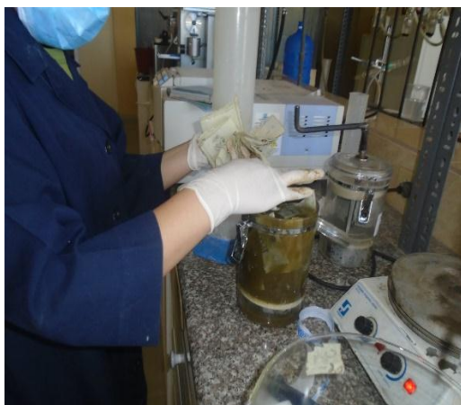
Fotografía No.25 Vasos de digestibilidad
