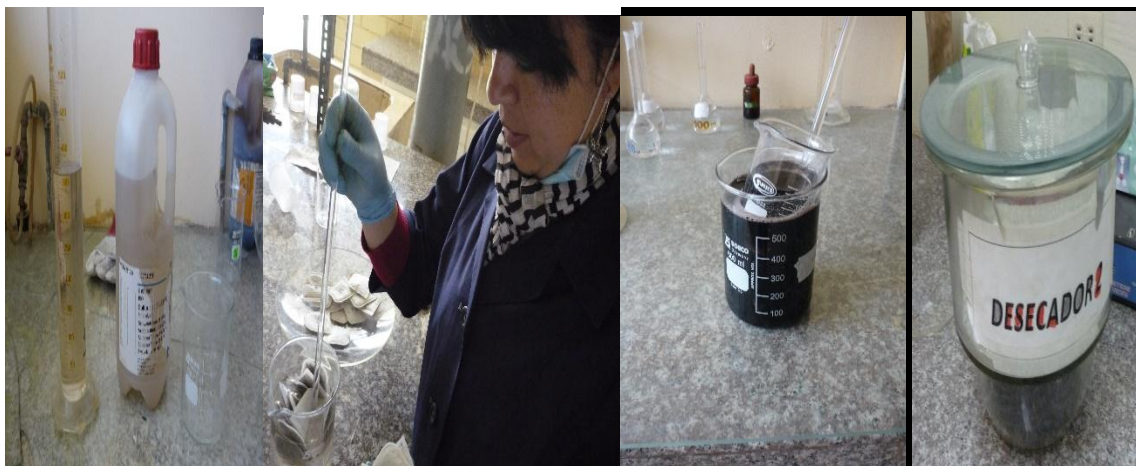
Fotografía No.15 Lignina detergente acida Método de Ankom
