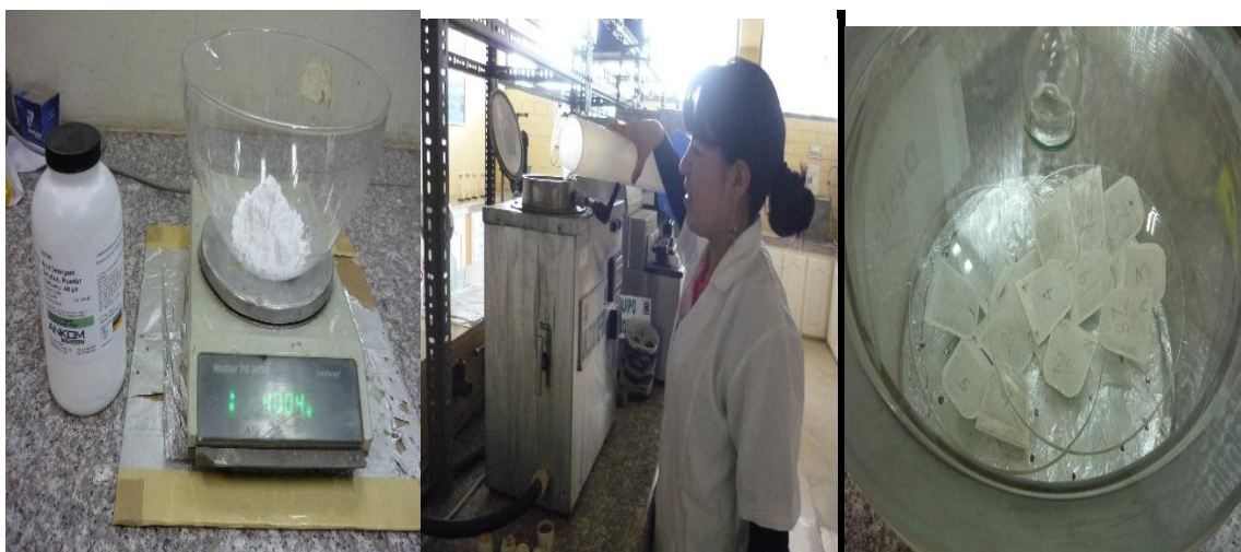
Fotografía No.14 Fibra detergente acida Método de Ankom
