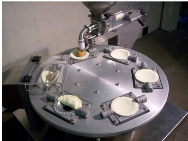
Figura 21. Alimentación 2 forma automática
