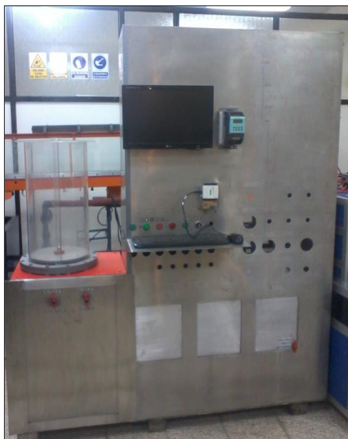
Figura 26. Condición inicial del Banco Generador de Vórtice
