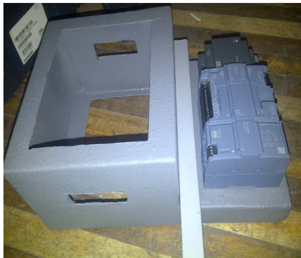
Figura 38. Montaje del PLC
