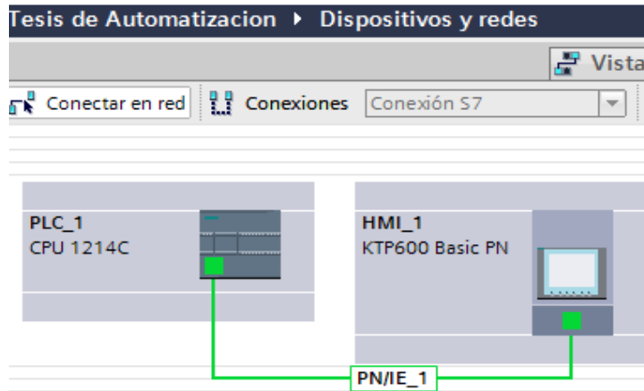
Figura 75. Comunicación Profinet entre PLC y HMI
