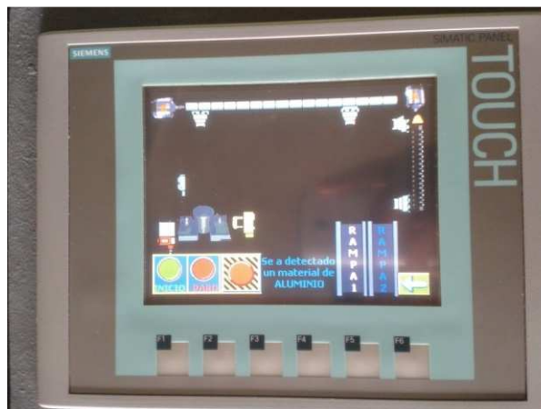
Figura 51. Pantalla de funcionamiento automático
