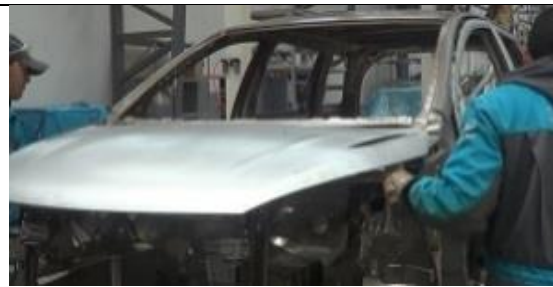
Figura 36-3: Colocación y ajuste de la cubierta del motor (capot)
