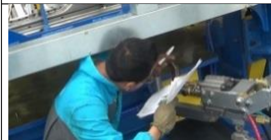
Figura 21-3: Marcación de los puntos de soldadura
