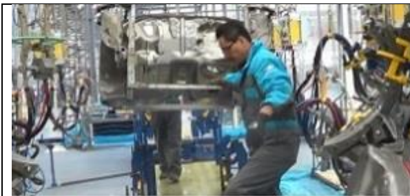
Figura 31-3: Traslado, posicionamiento de compartimento, piso delantero, posterior del JIG 4
