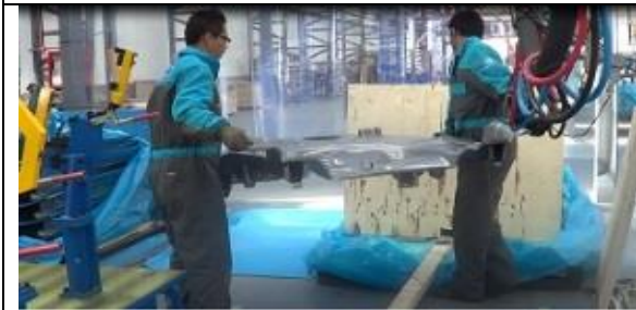
Figura 9-3: Transporte del piso delantero
