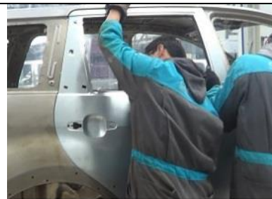
Figura 34-3: Colocación y ajuste del conjunto de la puerta trasera izquierda
