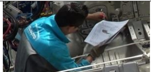
Figura 14-3: Marcado de los puntos de soldadura
