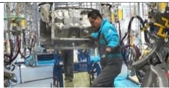
Figura 20-3: Transporte del conjunto ensamble JIG 2 a JIG 3
