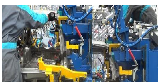
Figura 24-3: Verificación de los puntos de soldadura
