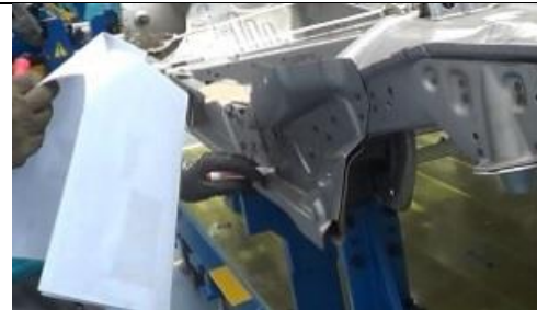
Figura 18-3: Verificación de los puntos de soldadura
