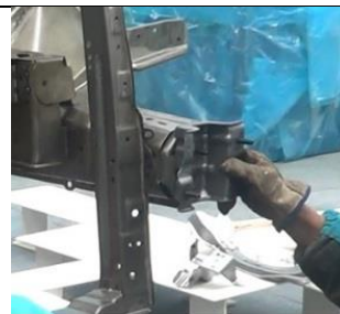
Figura 32-3: Colocar el corchete para viga de parachoques delantero derecho y ajuste
