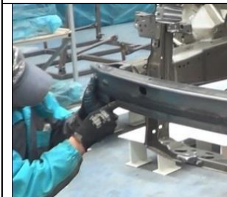
Figura 33-3: Colocación y ajuste de parachoques delantero derecho
