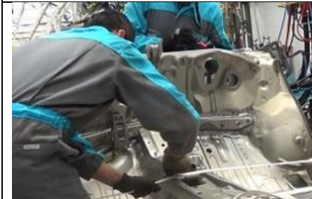
Figura 17-3: Colocación del soporte airbag
