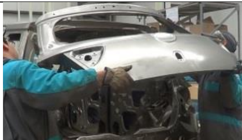
Figura 37-3: Colocación y ajuste del conjunto de la puerta trasera
