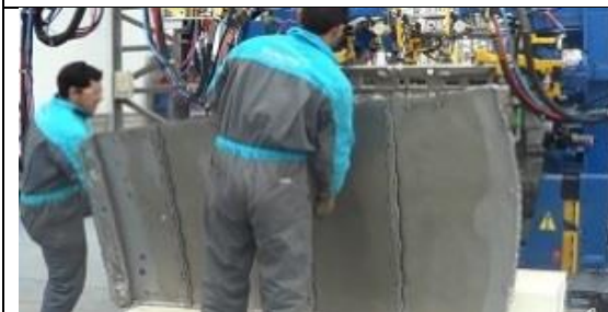
Figura 23-3: Colocación y ajuste del techo de la cabina
