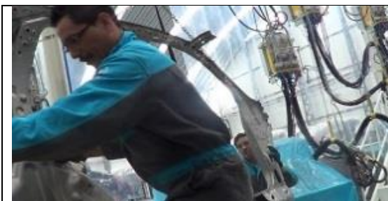
Figura 19-3: Transporte del conjunto de la parte lateral derecha e izquierda
