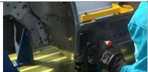
Figura 12-3: Verificación de los puntos de soldadura
