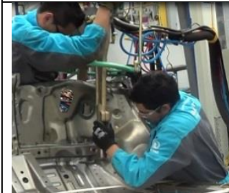
Figura 15-3: Proceso de soldadura con pistolas de punto
