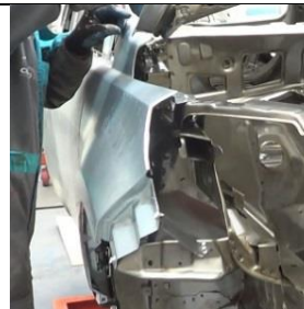
Figura 38-3: Colocación y ajuste de guarda faro derecho
