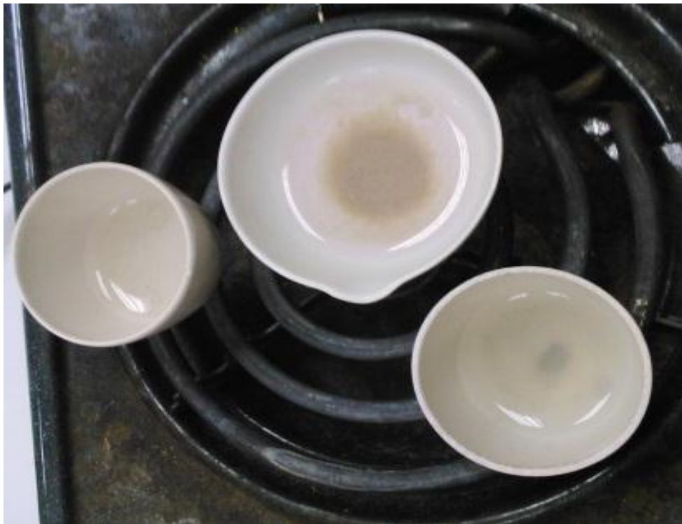
Fotografía N° 6: Ensayo de Cenizas Solubles en agua
