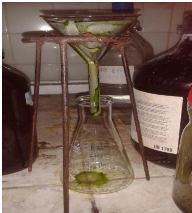
Fotografía N° 8: Filtración del extracto
