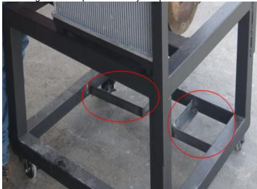
Figura 29. Soporte batería y tanque de combustible
