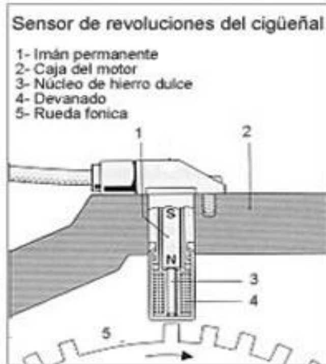
Figura 6. Sensor de revoluciones del cigüeñal
