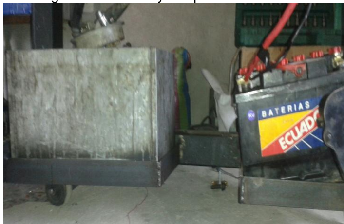
Figura 34. Batería y tanque de combustible
