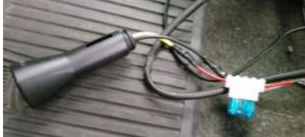
Figura 37. Reductor de voltaje instalado en el vehículo.
