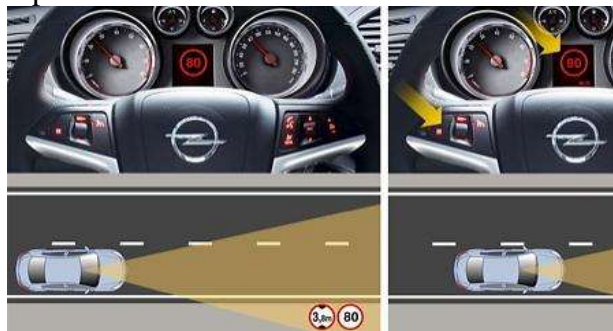
Figura 8. Ejemplo de funcionamiento del sistema de detección de señales.
