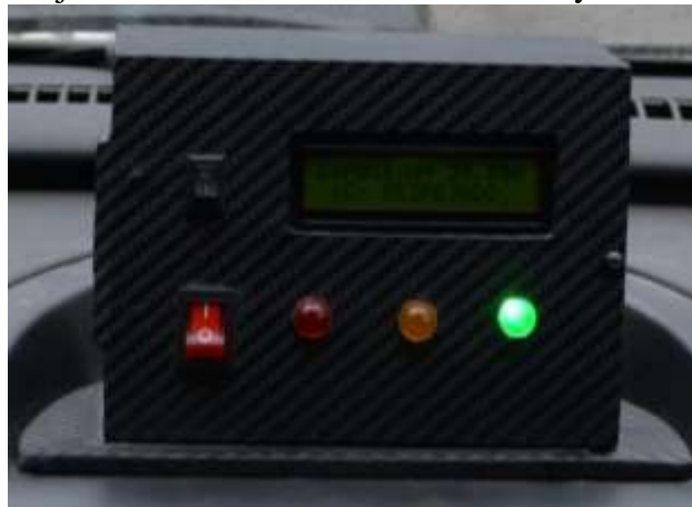
Figura 32. Conjunto de elementos de visualización y control del sistema.
