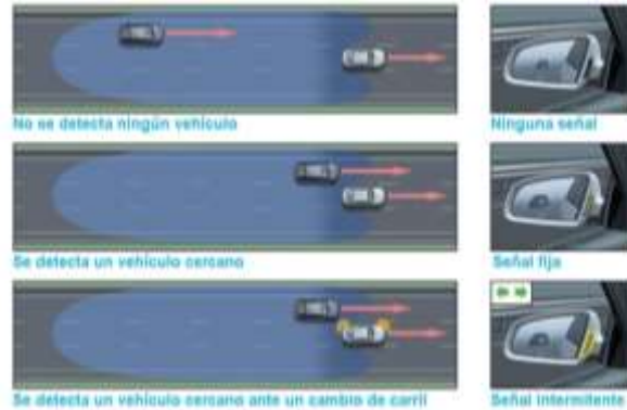
Figura 6. Funcionamiento del sistema de asistencia al cambio de carril
