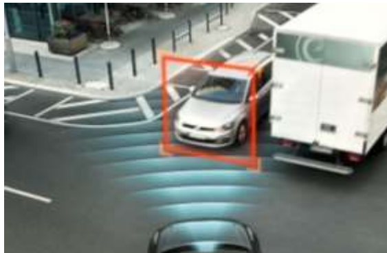
Figura 9. Sistema de frenada autónoma en intersecciones de la marca Volvo
