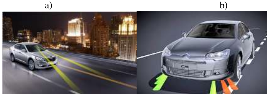
Figura 3. Ejemplos de sistemas LWDS. a) Por medio de videocámara y b) por sensores infrarrojos
