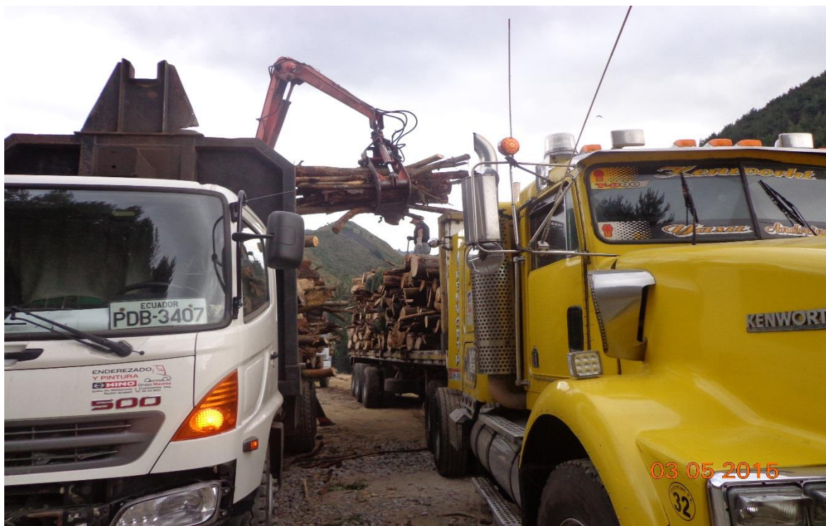
Fotografía 5. Carga de madera de pino con cargadora de brazo articulado
