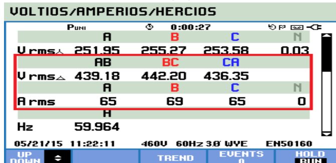
Figura 28. Lectura de Voltaje y corriente del analizador
