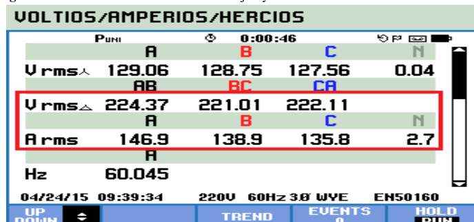
Figura 25. Lectura de Voltaje y corriente del analizador
