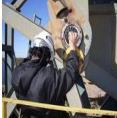
Figura 6. Monitoreo de rodamientos con ultrasonido pasivo
