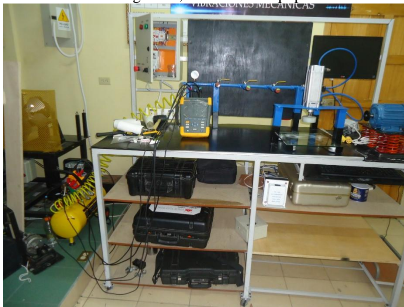
Figura 29. Medición en la fuga de 2,0 mm con el equipo ULTRAPROBE 15000
