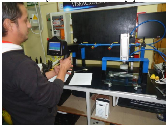
Figura 28. Medición en la fuga de 2,00 mm con el equipo ULTRAPROBE 15000
