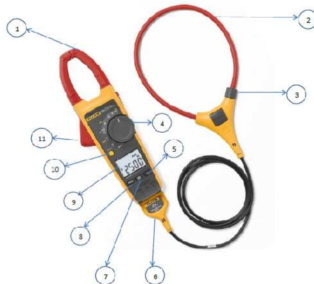
Figura 25. Componentes de la pinza amperimétrica FLUKE 376 y sonda iFLEX
