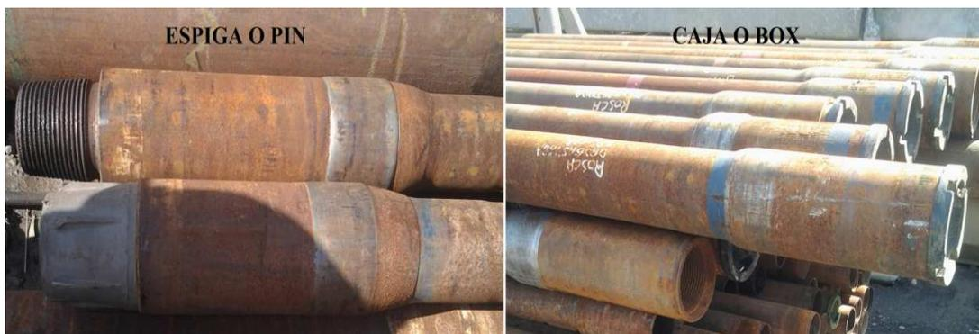
Fuente: Conexiones de tubería campamento base Nabors -Shushufindi
