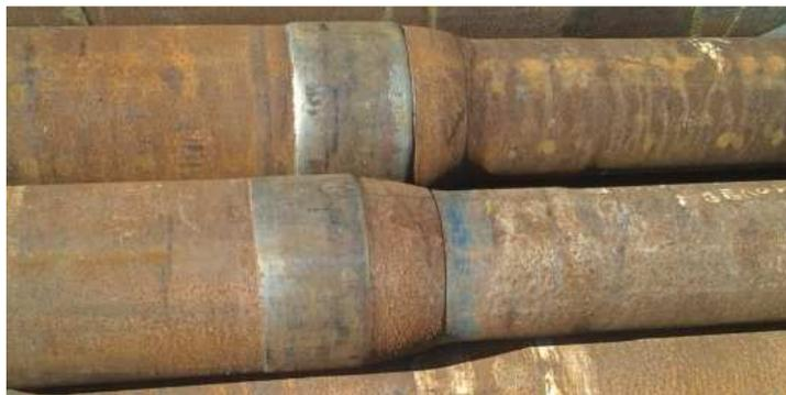
Fuente: Bandas de metal duro de la tubería de perforación base Nabors-Shushufindi
