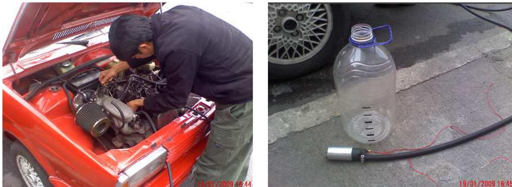
**FIGURA 4.1.** Conexión de Cañería a Riel de Inyectores. **FIGURA 4.2.** Recipiente de 5000cc.
