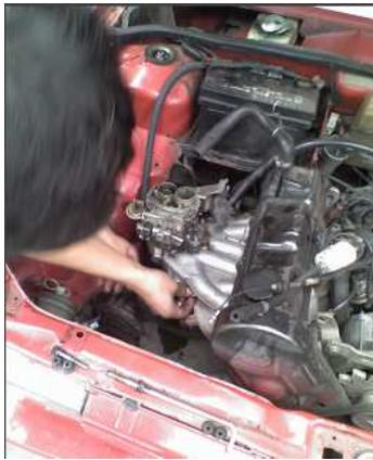
**FIGURA 3.24.** Desmontaje del Carburador.
