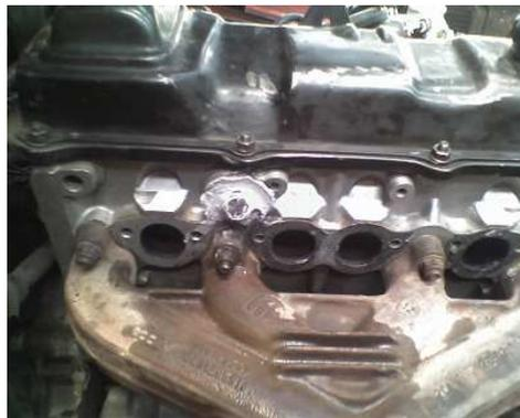
**FIGURA 3.26.** Sellado de la Cavidad de Refrigeración de Colector Admisión de Carburador.
