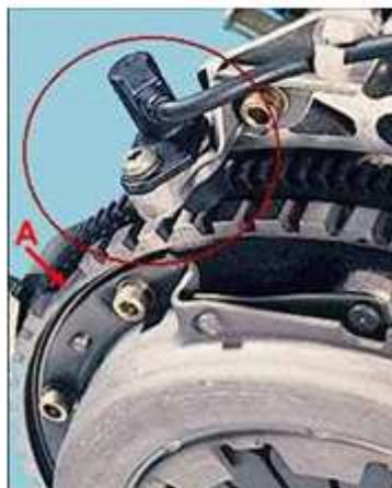
A: Indica la posición angular del cigüeñal al computador.
