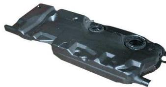
FIGURA 2.60. Tanque de Combustible.
