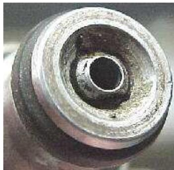
**FIGURA 2.55.** Inyector con Cono de Pulverización Ancho.
