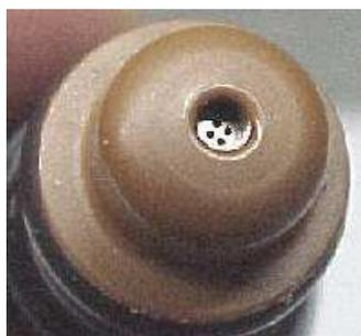
**FIGURA 2.53.** Inyector con Pulverización de Cono.
