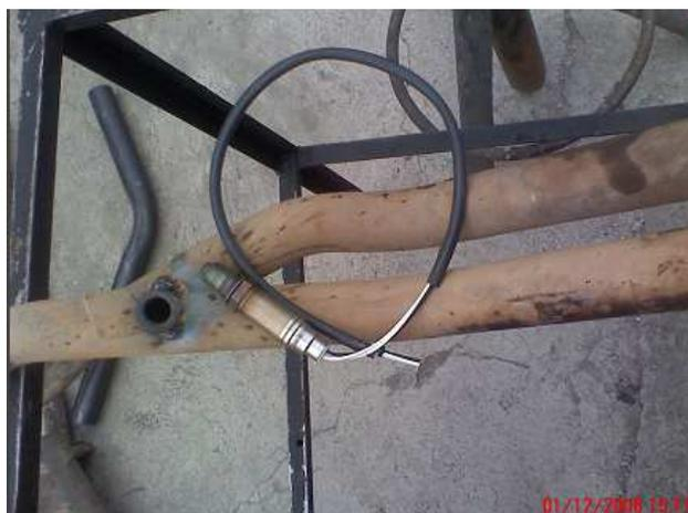
**FIGURA 3.29.** Ubicación y Montaje de Sensor de Oxígeno en Colector de Escape.
