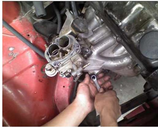
**FIGURA 3.25.** Desmontaje del Colector de Admisión.
