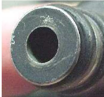
**FIGURA 2.54.** Inyector con Cono de Pulverización Interno.
