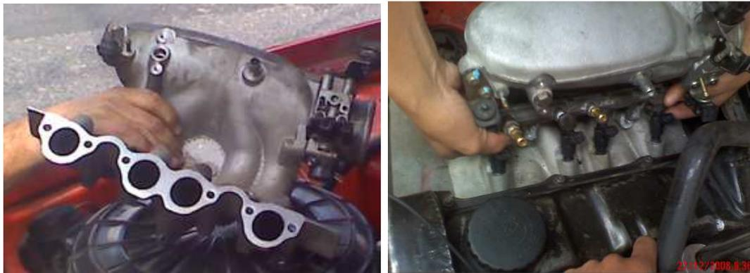
**FIGURA 3.27.** Montaje de Elementos Externos del Múltiple. **FIGURA 3.28.** Ubicación del Múltiple.
