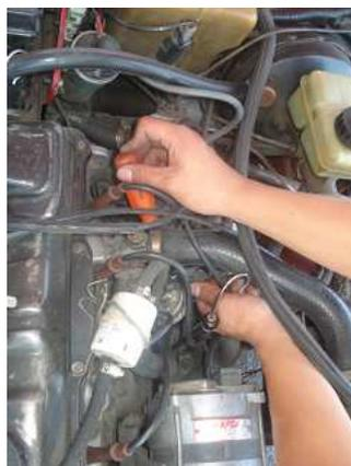
FIGURA 3.1. Cañería de la Bomba de Combustible.
