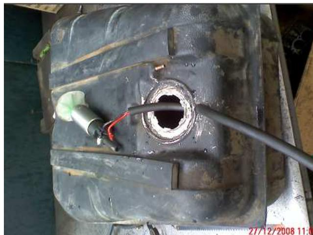
**FIGURA 3.32.** Ubicación y Montaje de la Bomba de Combustible dentro del Depósito de Combustible.
