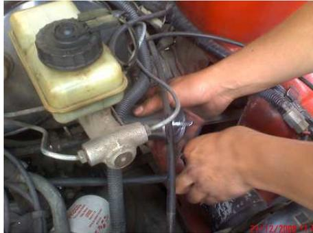
**FIGURA 3.33.** Ubicación y Montaje de Filtro de Combustible.
