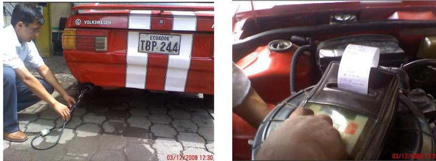
**FIGURA 3.6.** Analizador en el Tubo de Escape del Vehículo. **FIGURA 3.7.** Resultados de Gases de Escape.
