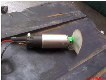
**FIGURA 3.16.** Bomba de Combustible (Bosch).
