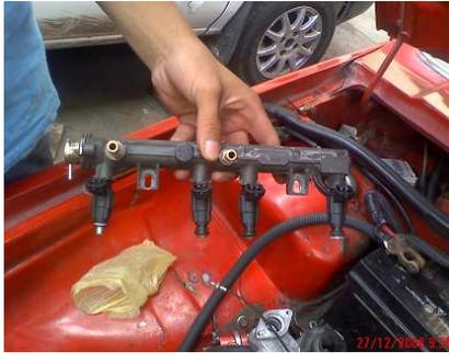
**FIGURA 3.17.** Riel de Inyectores (Magnetti Marrelli).
