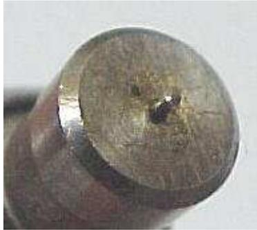
**FIGURA 2.52.** Aguja del Inyector.
