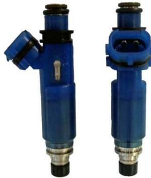
**FIGURA 2.49.** Inyectores de Combustible.
