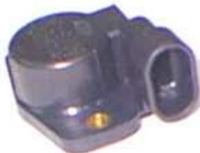
**FIGURA 3.21.** Sensor de Posición de la Mariposa TPS (Throttle Position Sensor).
