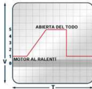
**FIGURA 2.16.** Forma de Onda del Sensor de Posición de la Mariposa del Acelerador TPS.
