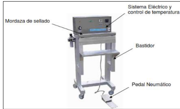
Figura 4. Selladora manual con bastidor y actuador neumático
