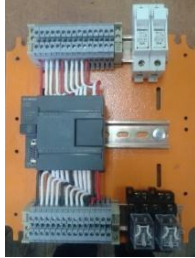
Figura 19. Montaje y conexiones del S7-200
