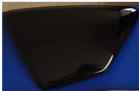
Figura 57. Tapa lateral con cera desmoldante
