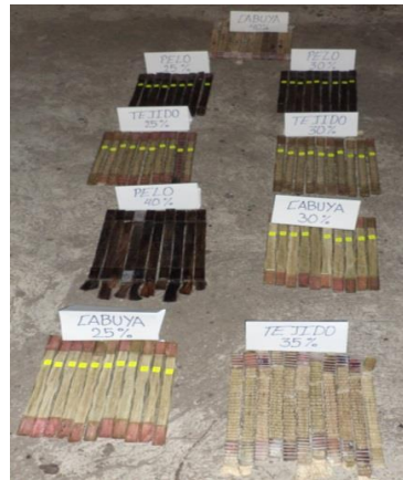
Figura 29. Probetas de tracción a ensayar construidas
