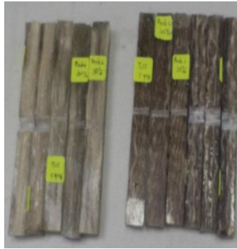
Figura 33. Probetas de impacto a ensayar construidas
