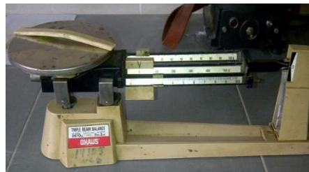
Figura 26. Masa de la matriz compuesta con refuerzo de cabuya
