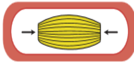
Figura 9. Carga compresivas en la matriz
