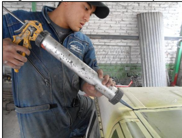
Figura 72. Impermeabilización de las juntas
