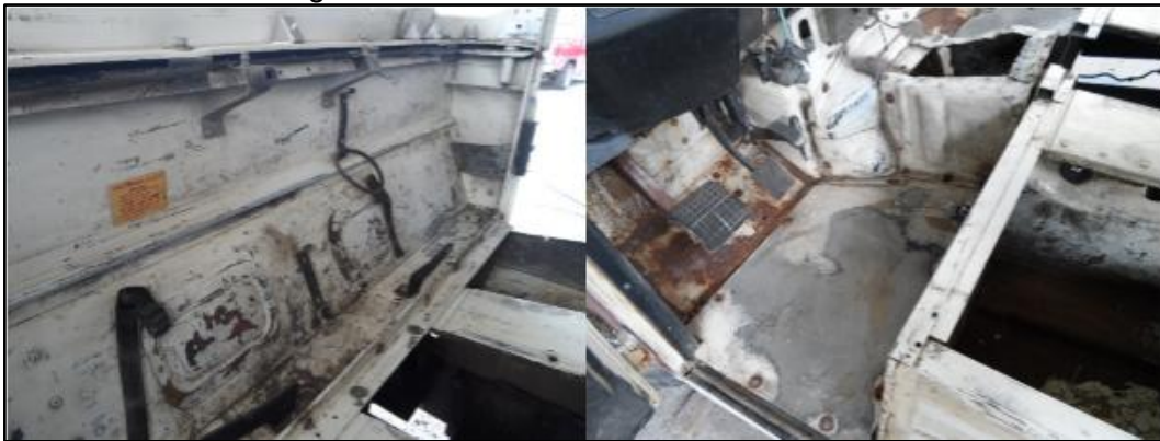
Figura 22. Áreas oxidadas de la carrocería
