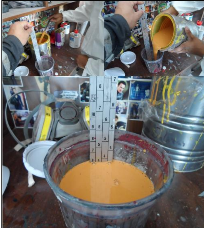
Figura 91. Catalización de la pintura en base a agua
