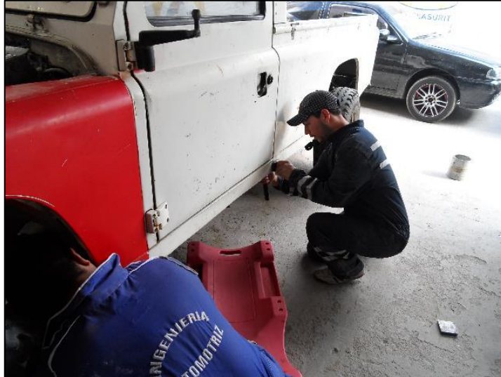
Figura 39. Enderezado de daño lateral
