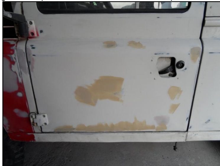
Figura 24. Aplicación de la masilla sobre la superficie oxidada
