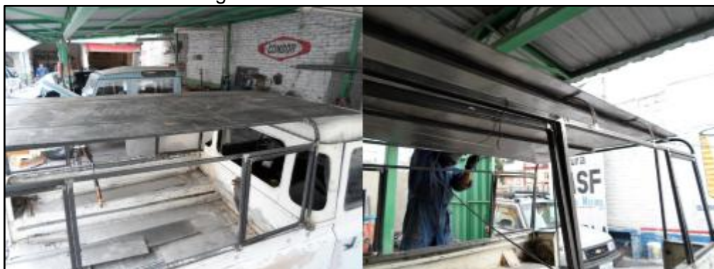
Figura 68. Recubrimiento del techo.
