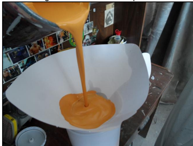
Figura 92. Filtrado de la pintura
