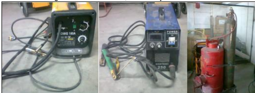
Figura 33. Suelda MIG, eléctrica y oxisuelda
