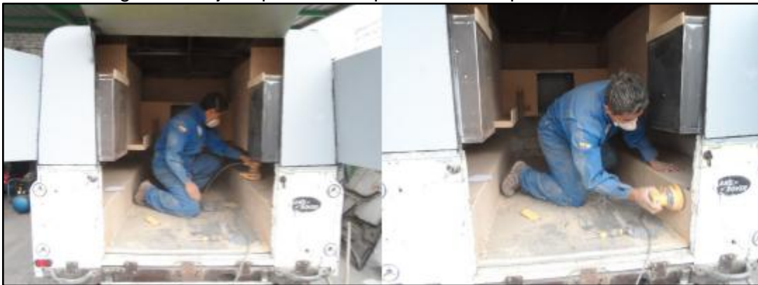
Figura 80. Lijado previo a la aplicación de impermeabilizante.
