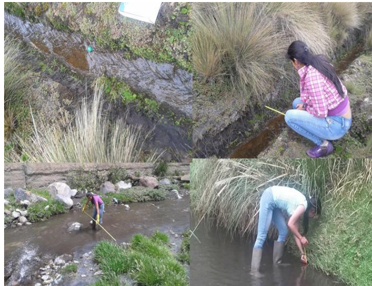
Fotografía 4-2: Determinación de caudales por el método del flotador.
