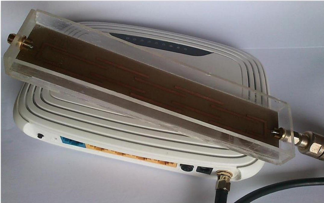
Fig. 4.41: Filtro Instalado en el Punto de Acceso
