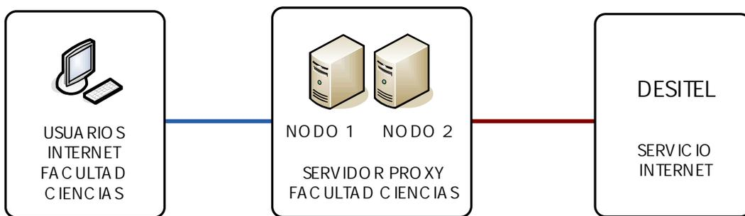
Figura 3.3 Infraestructura de redundancia
