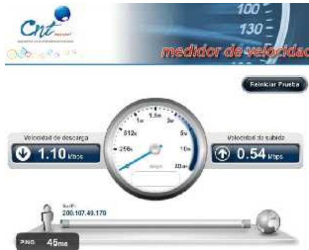
Fig. 4.11 Medición Ancho Banda ADSL
