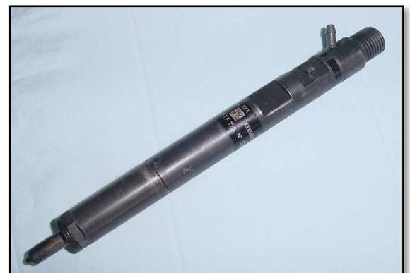
Se energiza el solenoide de la válvula de control la cual sube permitiendo que disminuya la presión en la cámara de control ya que el combustible se envía a la línea de retorno, la boquilla aun permanece cerrada hasta que la presión en la cámara sea la mínima lo que hace ascender al asiento de la boquilla permitiendo la inyección.
