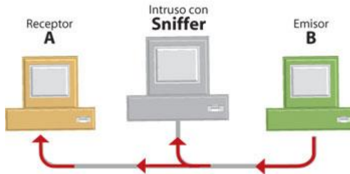
Figura II. 9.-Ataque de ARP Spoofing con hombre en el medio Fuente: http://www.enterate.unam.mx/Articulos/2007/enero/voip.htm . [12]
