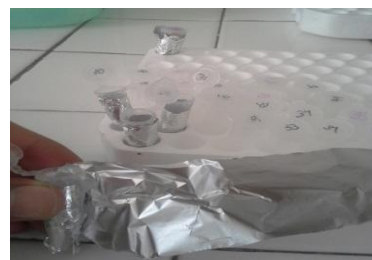
FOTOGRAFÍA N° 24 Separación del suero en tubos eppendorf cubiertos con papel aluminio
