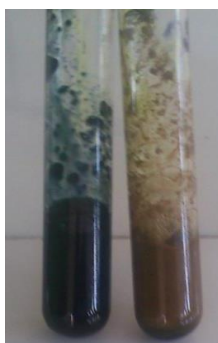
FOTOGRAFÍA No 06. PRUEBA DE CLORURO FERRICO DE LAS TINTURAS. LABORATORIO DE PRODUCTOS NATURALES. FACULTAD DE CIENCIAS. ESPOCH. MAYO 2014.
