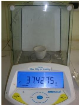
FOTOGRAFÍA N°16. PESO DE LOS CRISOLES CON MUESTRA
