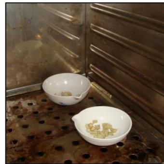
FOTOGRAFÍA N° 11. CÁPSULAS CON MUESTRAS EN LA ESTUFA
