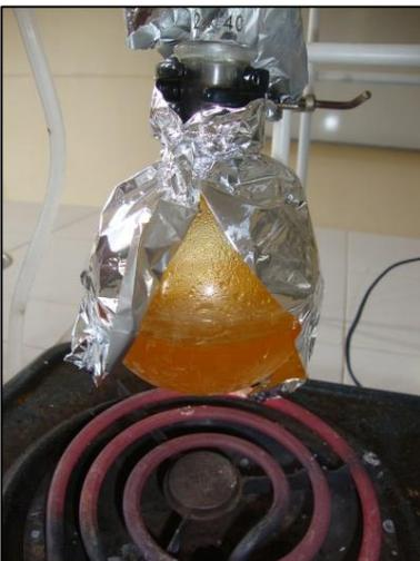
FOTOGRAFÍA N°28. FINAL DEL REFLUJO DE LA MUESTRA DE PROPÓLEO
