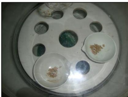
FOTOGRAFÍA N° 12. CÁPSULAS CON MUESTRAS TARADAS DESPUÉS DE DESECARSE.
