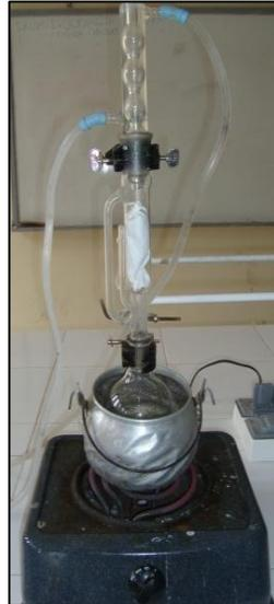
FOTOGRAFÍA N°26. EQUIPO SOXHLET ARMADO
