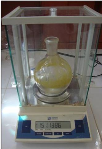
FOTOGRAFÍA N°35. PESO DEL BALON VACIO DE LA PRIMERA EXTRACCIÓN
