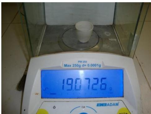
FOTOGRAFÍA N°18. PESO FINAL DE LOS CRISOLES CON MUESTRA
