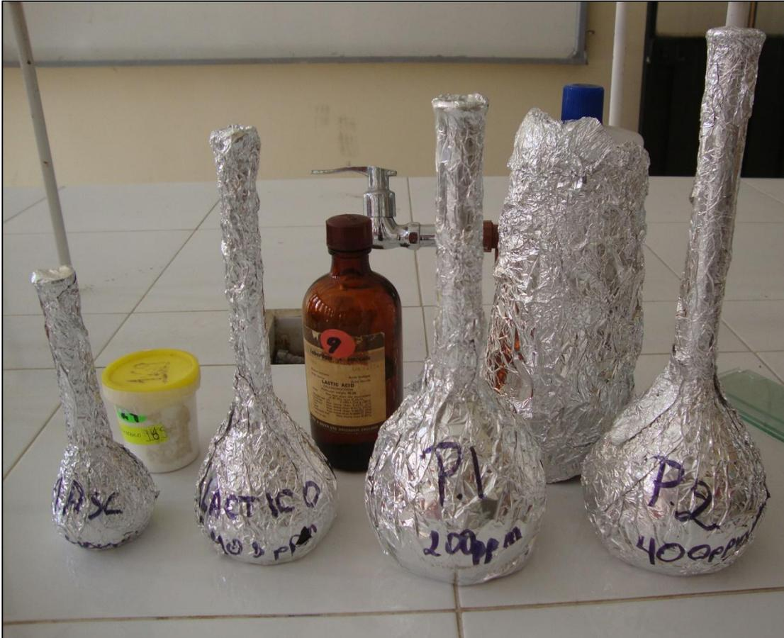
FOTOGRAFÍA N° 7. CONSERVANTES PREPARADOS, Ácido Ascórbico 400 ppm, Ácido láctico 400 ppm, Extracto acuoso de propóleo 200 ppm y 400 ppm.
