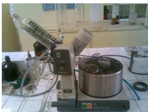
FOTOGRAFÍA N° 2. Concentración de Saponinas Hidrolizadas por medio de un Rotavapor
