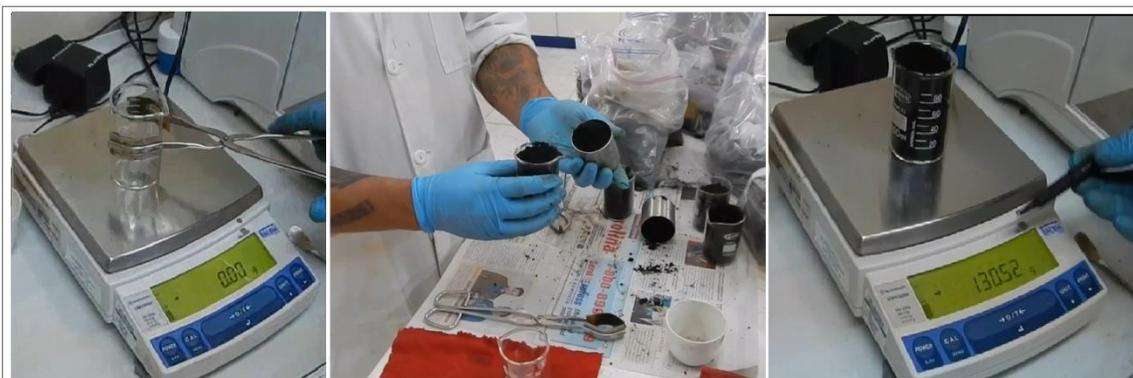
**Calculo de la densidad aparente del suelo utilizando la metodología del cilindro de volumen conocido.**
