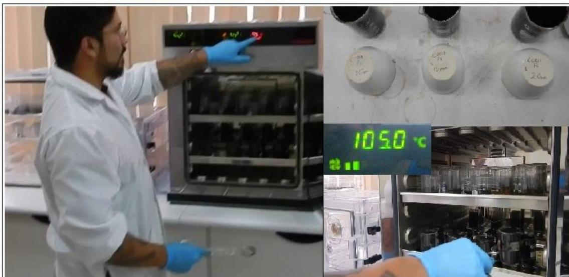
Pesadas las muestras de suelo (Peso húmedo) y colocadas en la estufa durante 24 horas a 105 °C para la determinación del peso seco y el cálculo de la densidad aparente.
