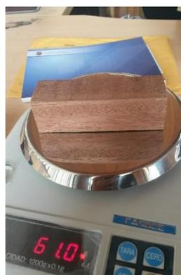
Probeta 3 seco al horno
