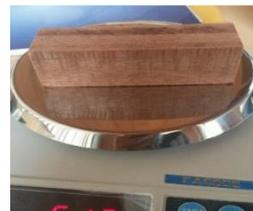
Probeta 2 seco al horno
