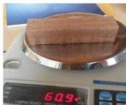
Probeta 1 seco al horno
