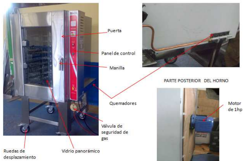
Figura 2.1.1.2.a: Partes principales del modelo HCG – S10
